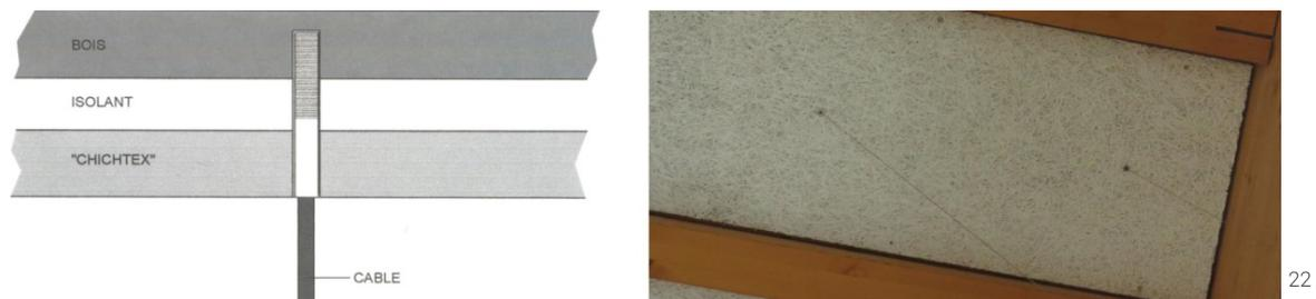
A l'autre extrémité, le câble permet de maintenir le module à la hauteur souhaitée. Ce fil est fixé ponctuellement au centre de chaque élément carré. Cependant, ce point de fixation qui se doit d'être le plus invisible possible, est réalisé de façon suffisamment précise pour que tous les modules n'aient pas le même centre de gravité.
